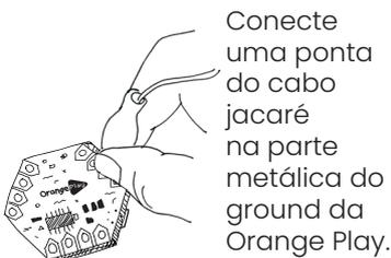
Conecte uma ponta do cabo jacaré na parte metálica do ground da Orange Play.
